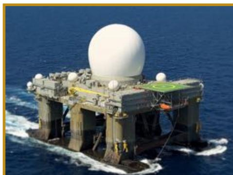
Le SBX-1 est une station radar flottante autopropulsée, radar mobile conçu pour être capable d'opérer par vents violents et grosses mers. Il fait partie de l'agence de défense du département missile de la Défense américaine, le Système de Défense de Missile Balistique (BMD). Il est monté sur une plateforme catamaran de forage semi-submersible de cinquième génération CS-50. Voir le reportage de G Captain :
